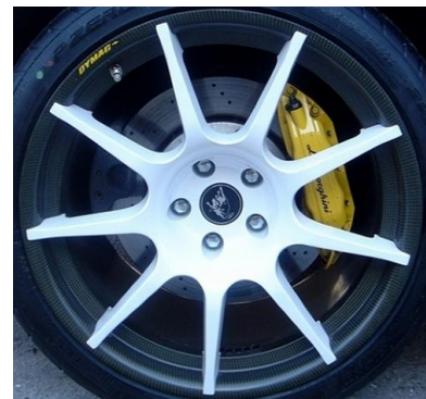
Kuva 9 Dymag:in valmistama hiilikuituvanne magnesiumkeskiöllä (32)
