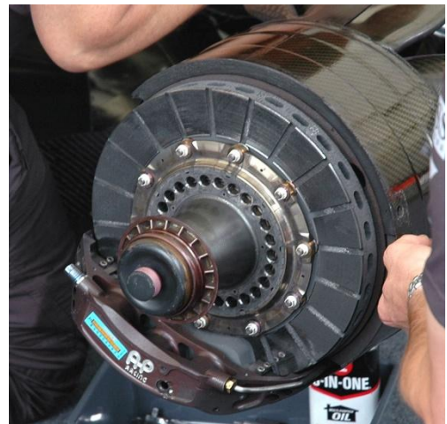
Kuva 3, MC Laren MP4/20 jarrulevy, hiili-hiilikuitu, www.gurneyflap.com
