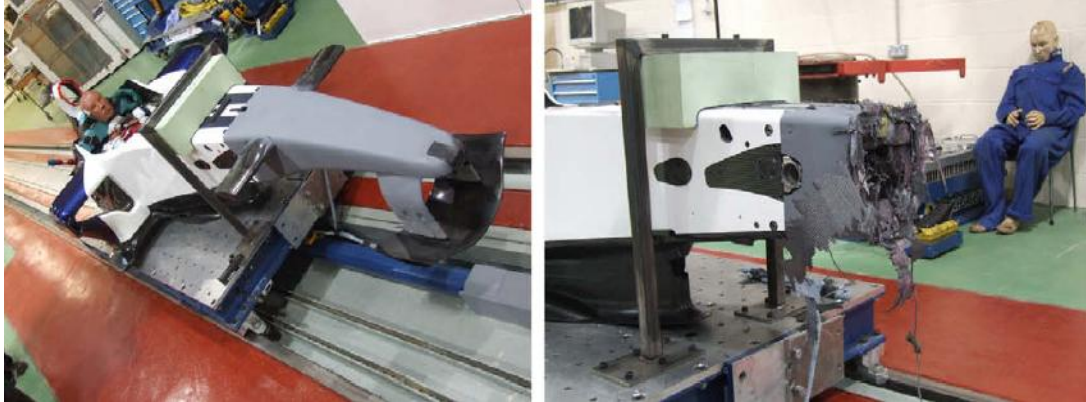
Kuva 7 Hiilikuidun hallittu murtuminen törmäystestissä (5 s. 114)
